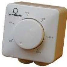
Dieses Potentiometer ist zur Steuerung von Stellantrieben oder EC-Lüftern konzipiert. Es ist in einem spritzwassergeschützten Gehäuse montiert und kann für die Inputz- sowie für die Aufputzmontage verwendet werden. Es liefert ein stetig Ausgangssignal zwischen 0 - 10 V DC, einstellbar mit internen Trimmern: V1 und V2. Das Potentiometer hat eine Aus-Position.
