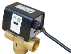
Zonenventile der Reihe ZV-S werden für alle Heiz- und Kühlanlagen empfohlen, bei denen eine Sicherheitsfunktion im Fall einer Unterbrechung der Stromversorgung gefordert wird. In einem entsprechenden Fall wird die Feder sicher geschlossen.
